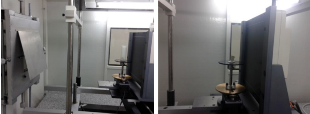
Fig. 1. interior de la zona de irradiación de la línea de rayos X
