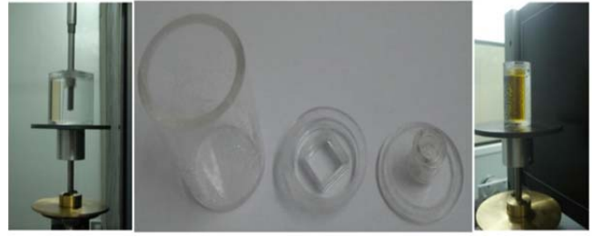
Figura 4. Configuración para mediciones y ensayos en el equipamiento de micro-tomografía de LIIFAMIR X . Cámara de ionización insertada en fantoma cilíndrico (50 mm de diámetro y altura) agua-equivalente (izquierda), accesorios para fantoma (centro) y gel dosimétrico (derecha).
