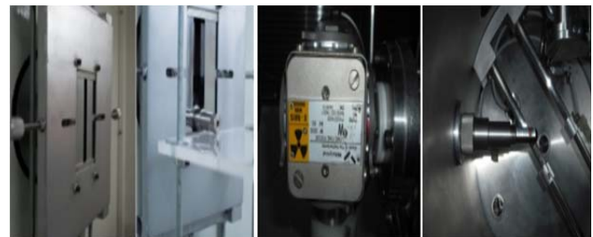
Figura 3. Componentes de electrónica y mecánica del equipamiento de micro-tomografía de LIIFAMIR X : sistemas de colimación (izquierda), fuente de radiación (centro) y sistema de alineación (derecha).
