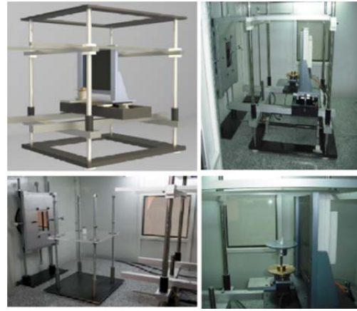
Figura 2. Sistema de detección para micro-tomografía en la línea integral de LIIFAMIR X : Diseño Computed Aid Assisted - CAD (arriba a la izquierda) y fotografías del sistema de detección dentro del bunker.
