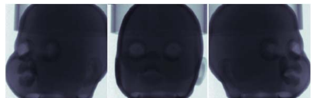
Figura 7. Ensayos preliminares en fantoma antropomórfico de cabeza lleno de gel dosimétrico (agua-equivalente) en el equipamiento de \mu CT de LIIFAMIR X .
