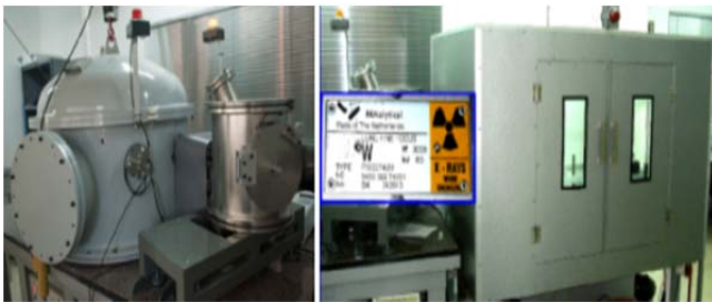
Figura 1. Equipamiento de micro-tomografía en la línea integral de imágenes por rayos X en LIIFAMIR X . Las muestras son analizadas dentro del bunker mostrado en la figura de la derecha.
