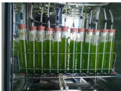
Figura 1. (arriba) Cultivo de Scenedesmus obliquus en biorreactores tipo columna de burbujeo con sistema de agitación por aireación.
