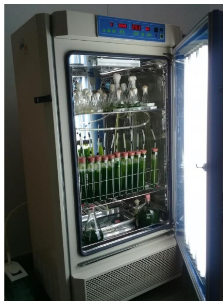
Figura 1. (arriba) Cultivo de Scenedesmus obliquus en biorreactores tipo columna de burbujeo con sistema de agitación por aireación.
