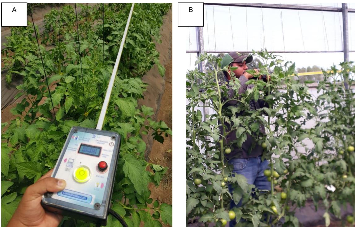
**Imagen 40.** Ceptómetro (A). Medición de radiación interceptada en tomate (B)
