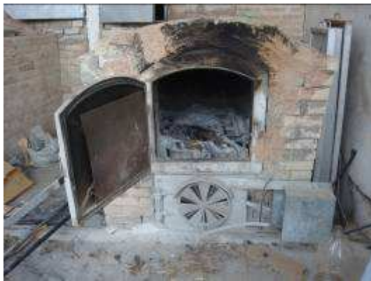
Figura 2 - Quemador del secadero (izquierda), caños de conducción de gases de combustión (derecha).
