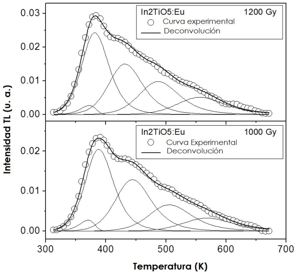
Figura 5. Deconvolución de las curvas de brillo asumiendo el modelo de cinética de orden general para  $\text{In}_2\text{TiO}_5:\text{Eu}$  expuesto a dosis de 1200 y 1000 Gy de radiación gamma.
