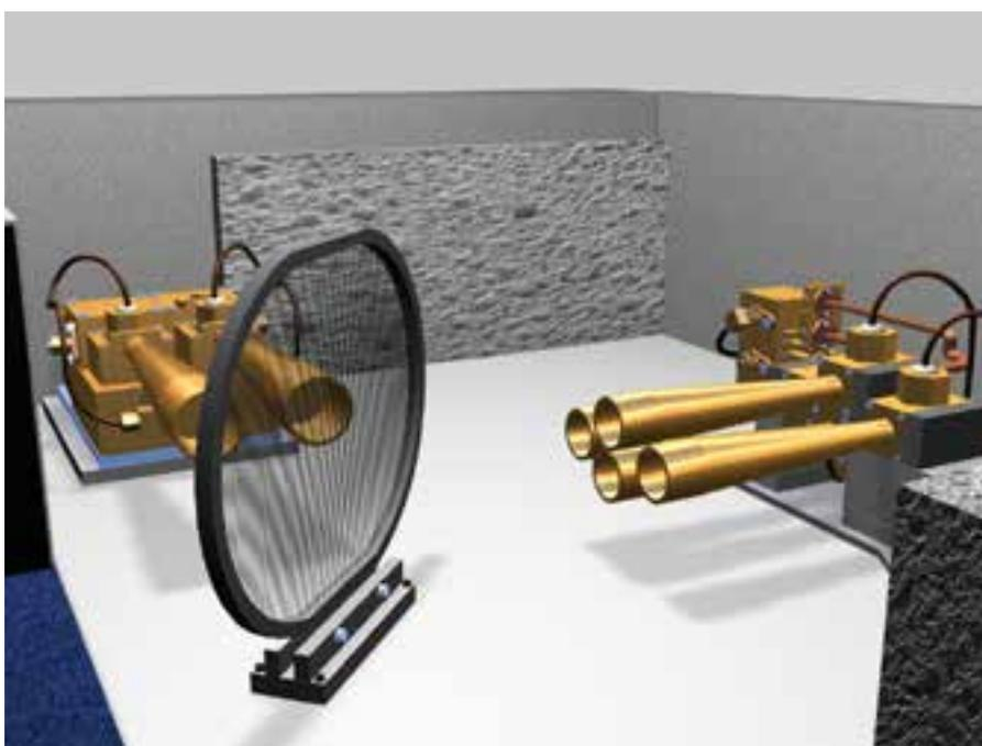
**Izquierda.** El SST con el radomo abierto durante su instalación. Puede verse la antena y la caja de los radiómetros (*front-end*). **Derecha.** Representación 3D del *front-end*. Se pueden ver las dos cornetas de los receptores de 405GHz (izquierda) y las cuatro cornetas de los receptores de 212GHz (derecha). La red (*grilla*) gris sirve como semirreflector para dividir la señal de entrada y dirigirla a las cornetas.
