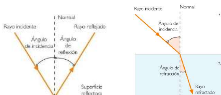
Fig. 2 – Izq: Esquema de la reflexión especular; Der: Esquema de la refracción.
