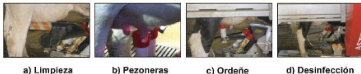
Figura 1 | Automatización de la rutina de ordeño: a) limpieza de pezones, b) identificación de pezones y colocación de pezoneras, c) ordeño, d) desinfección de pezones.
