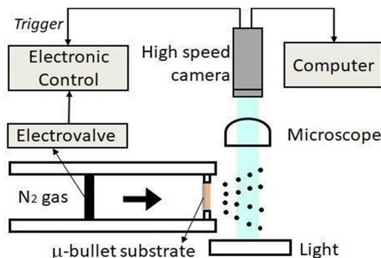
Figura 1: Esquema del acelerador de micropartículas.
