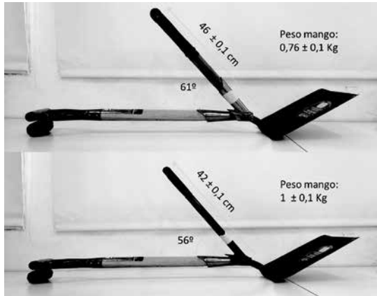
Figura 4: Pala ancha con cabo extra de madera (superior) y cabo extra de metal (inferior).
