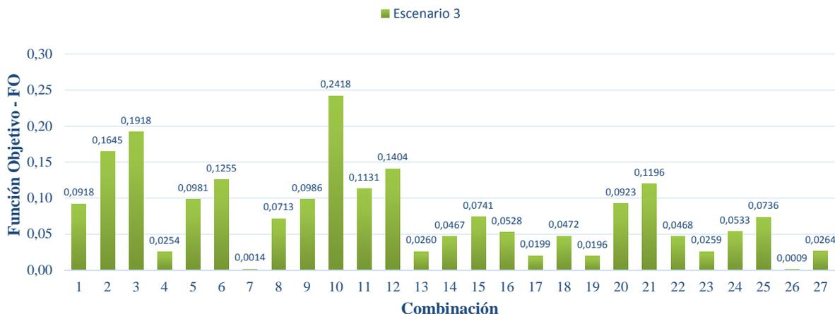
Fig. 8. Función objetivo para cada combinación de estructura-puesta a tierra - Escenario 3.
