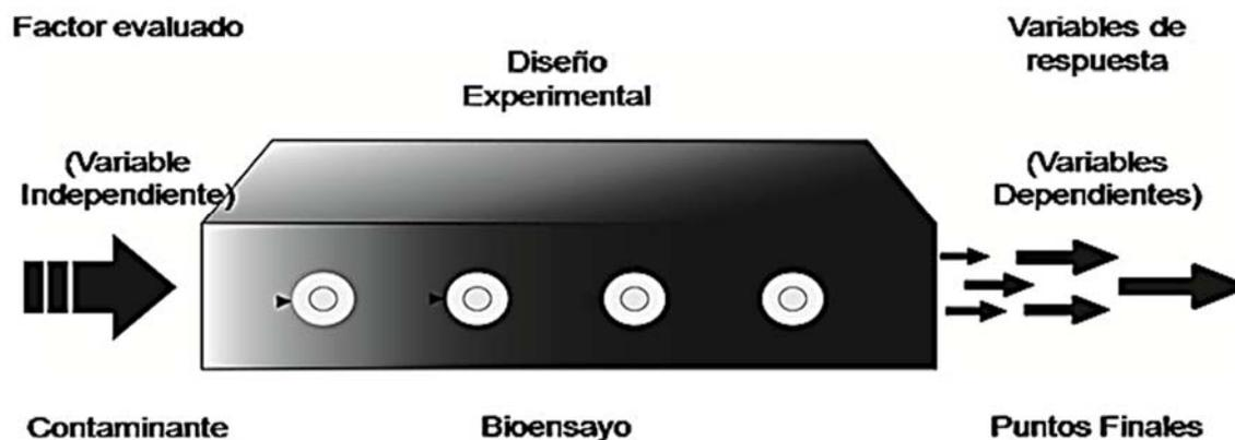
Figura 12.5 Esquema básico de diseño de experimento de un bioensayo de toxicidad
