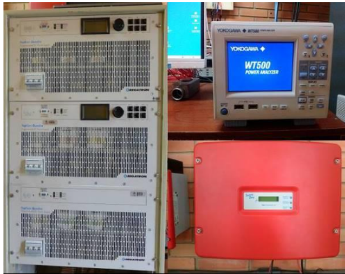
Figura 4: Simulador de módulos Fotovoltaicos, analizador de energía e inversor.
