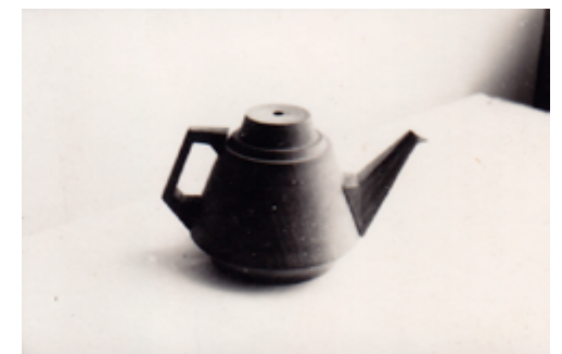
Figura 7. El inicio del proceso de fabricación de la tetera a partir de un molde en madera. (Archivo Fundación IDA).
