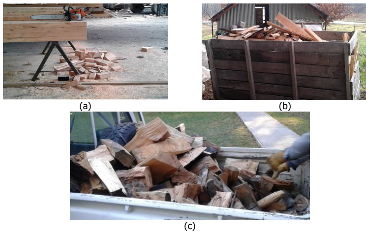
Figura 3. Despunte de tirantes (a), despunte de tablas (b) y partida (c). (Fuente: propia, 2020, CEAT, INTA)
