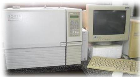
**Figura 33.** Cromatógrafo de gases para la cuantificación de AGVs.
