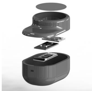
Fig. 1. Despiece del dispositivo desarrollado. Se encuentra conformado por un sensor piezoeléctrico, una etapa de acondicionamiento de señal, un sistema de adquisición y procesamiento y un módulo de comunicación inalámbrico.
