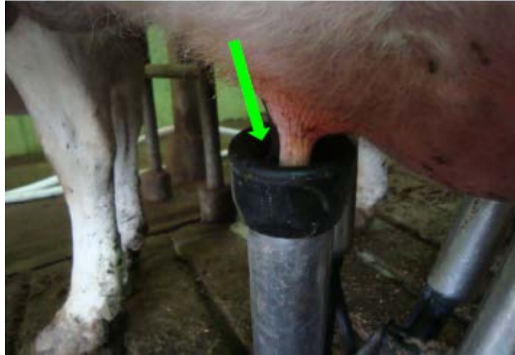
Foto 12 : Deslizamiento de pezonera.
