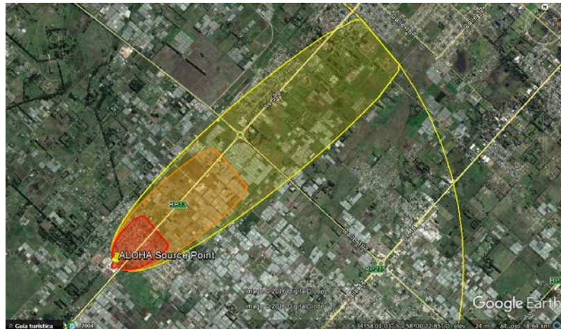
Figura 13: Atmósferas peligrosas estimadas con ALOHA para un escape de amoníaco desde un tanque receptor en un Frigorífico. Visualización con Google Earth.
