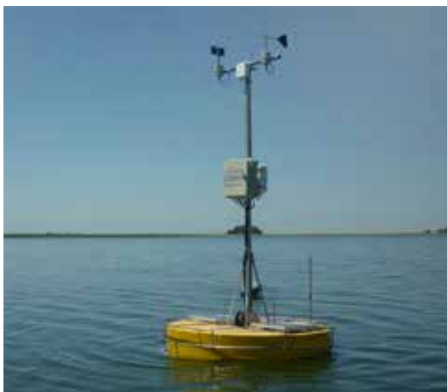
Boya de monitoreo continuo de las variables limnológicas estudiadas en el marco del proyecto PAMPA 2.
