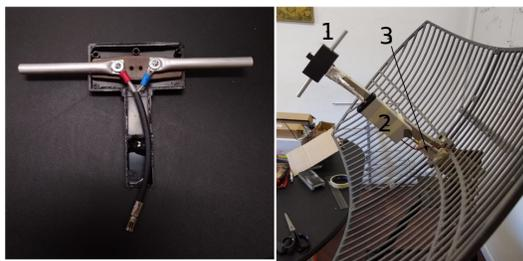
Figura 2: *Panel izquierdo*: se muestra el dipolo conectado a los terminales del cable coaxial. *Panel derecho*: se ve el sistema receptor de la antena ya montada, indicando con números: 1) el dipolo, 2) el módulo del LNA, y 3) el RTL-SDR.
