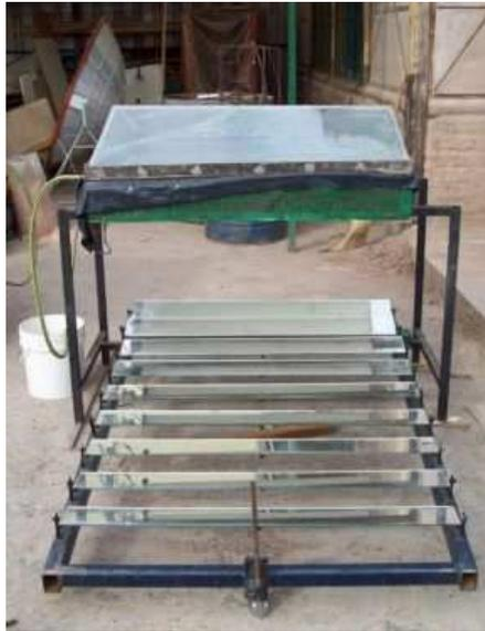
Figura 3: sistema completo batea y concentrador de fresnel.
