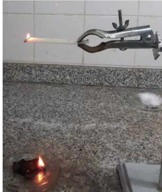
**Figura 5.** Ensayo de flamabilidad
