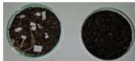
Figura 3.- Compost + bioplástico (izq: inicio, der: final del ensayo)
