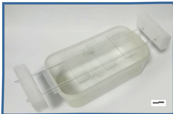
Figura 7.3: Portaobjetos en un soporte para tinciones sobre un recipiente plástico.
