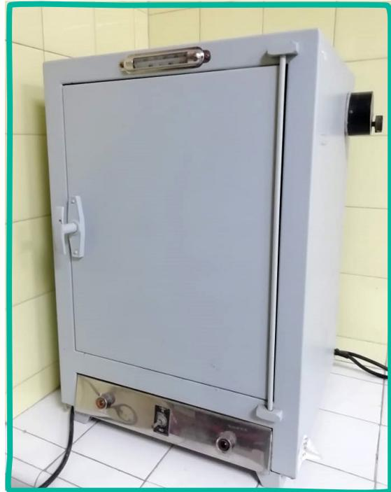
Figura 5.2: Estufa de incubación. Es una cámara de temperatura controlada para cultivo de microorganismos. Se utiliza para facilitar el desarrollo de los microorganismos a su temperatura óptima de crecimiento.
