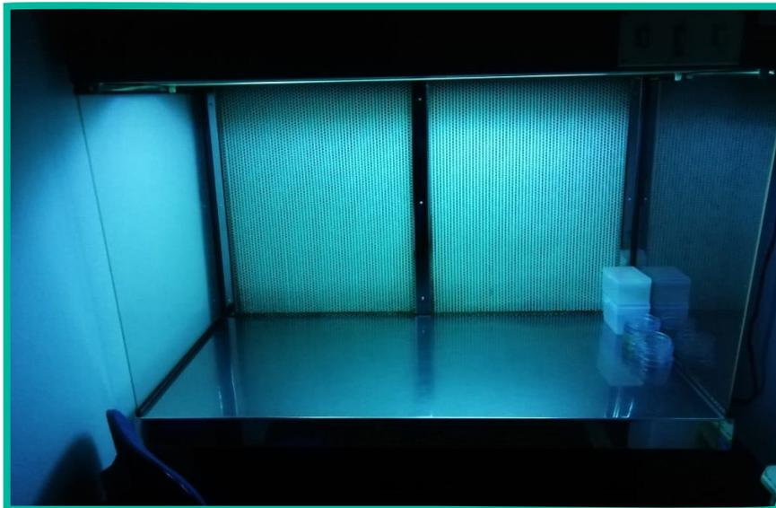
Figura 5.28: Cabina de flujo laminar con lámpara de radiación UV.
