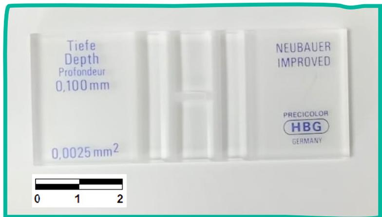
Figura 5.23: Cámara de Neubauer para recuento de células.
