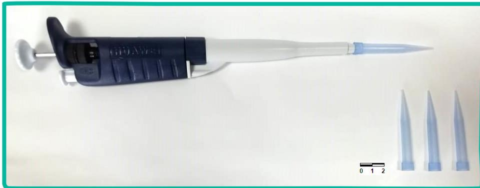
Figura 5.16: Micropipeta automática con punta autoclavable, se utiliza para fraccionar pequeñas cantidades de líquidos. Las puntas (tips) son descartables y de distinto tamaño y color según el modelo de micropipeta.
