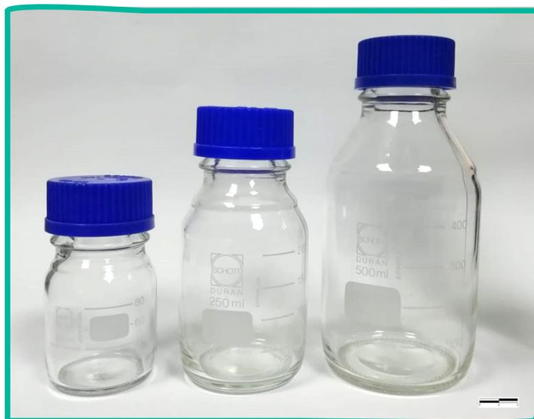
Figura 5.24: Frascos de tapa azul de diversos volúmenes. Se utilizan para esterilización de soluciones y medios de cultivos al resistir el proceso de esterilización en autoclave.
