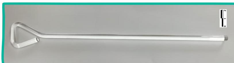
Figura 5.17: Asa acodada o espátula de Digralsky, se utiliza para la extensión de microorganismos sobre la superficie de un medio de cultivo sólido en placa Petri.
