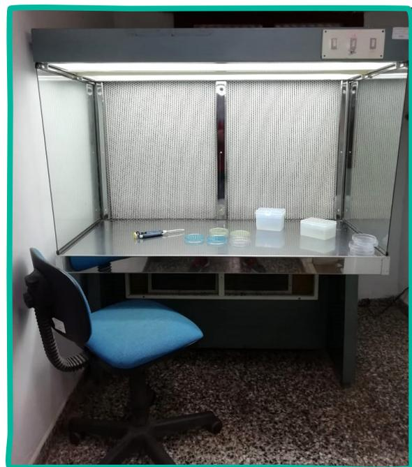
Figura 5.4: Cabina de flujo laminar.
