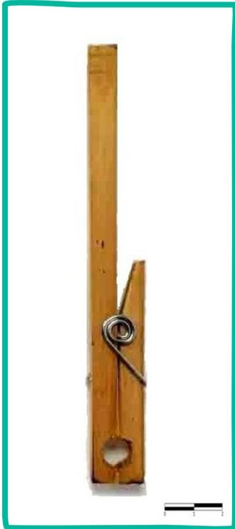
Figura 5.22: Pinza de madera, permite sostener portaobjetos para secar y fijar muestras con un mechero Bunsen.
