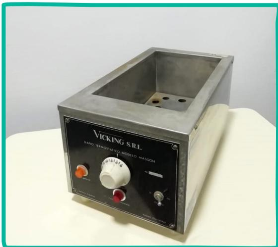
Figura 5.7: Baño termostático, contiene agua y un sistema de regulación de la temperatura. Se utilizan para atemperar medios de cultivo o incluso para incubar cultivos de microorganismos.
