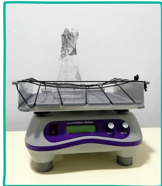
Figura 5.8: Agitador orbital.
