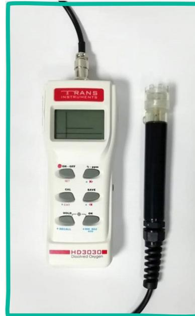
Figura 5.10: Oxímetro de membrana, mide concentración de oxígeno en medios líquidos.
