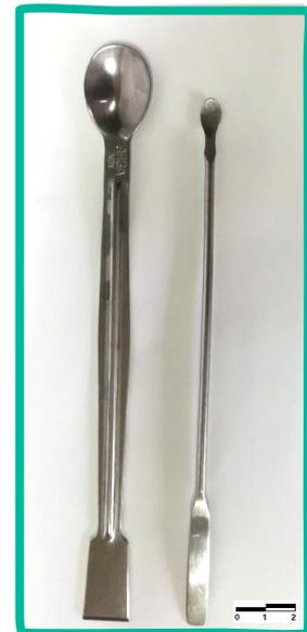
Figura 5.19: Cucharas y espátulas de laboratorio, se utilizan para fraccionar muestras o medios de cultivo.
