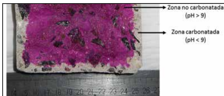
Figura 3. Determinación del espesor de la zona carbonatada por medio del rociado con fenolftaleína de la estructura a analizar.
