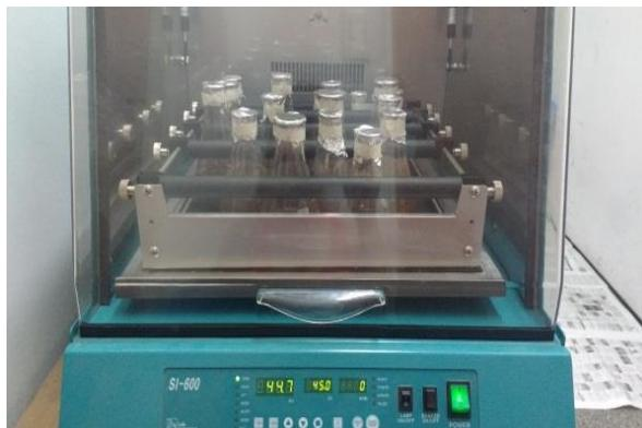
Figura 3. Agitador orbital termostatzado.
