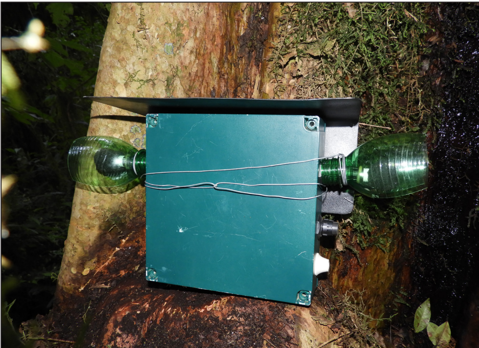
Figura 3.4.3. Protección contra los factores ambientales abióticos y bióticos de un grabador Wildlife Acoustics© Song Meter SM2 utilizado para la búsqueda acústica pasiva de Gastrotheca christiani . Foto: M. Boullhesen.
