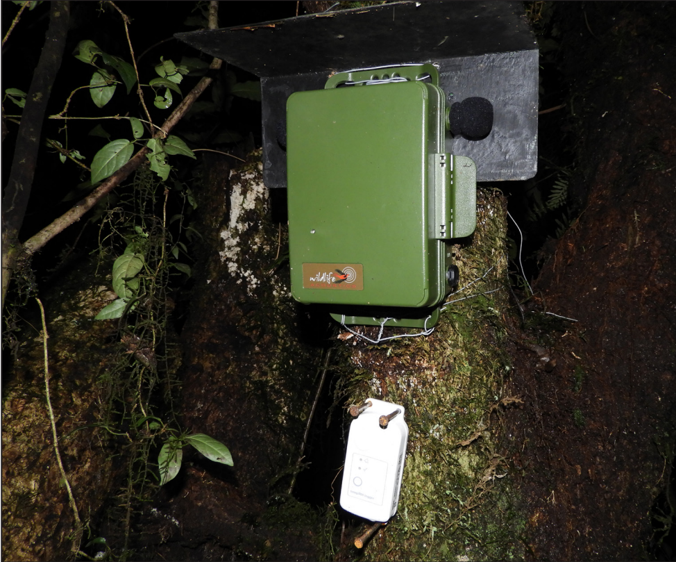
Figura 3.4.1. Descarga de datos de un registrador automatizado HOBO® MX2301 de temperatura y humedad ambiente acoplado a un grabador Wildlife Acoustics® Song Meter SM4 durante un estudio de los paisajes sonoros del Parque Nacional Calilegua. Foto: M. Boullhesen.
