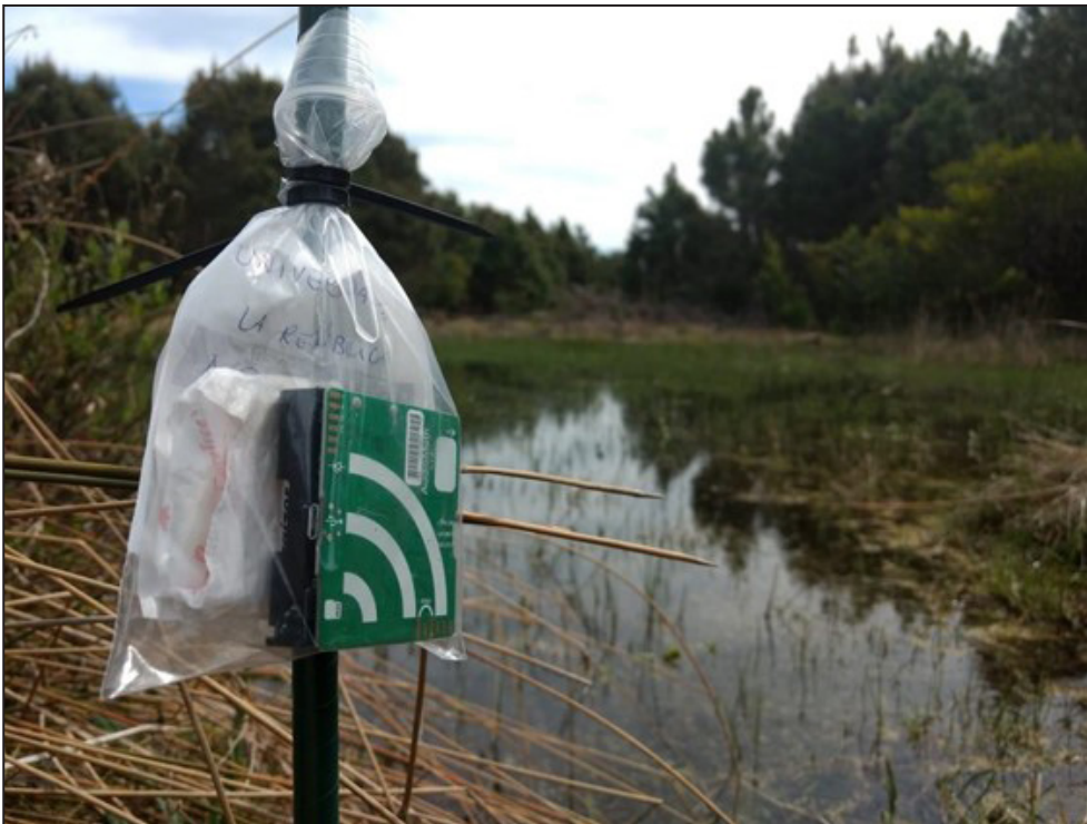
Figura 3.4.2. Grabador AudioMoth v1.1.0 utilizado para el monitoreo de Ceratophrys ornata en una charca temporaria, colocado dentro de una bolsa plástica hermética para protegerlo de la humedad. Foto: G. Agostini, proyecto Gigante de las Pampas (Facebook e Instagram: @gigantedelaspampas)
