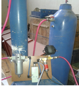
Figura 4.3: Vista parcial del circuito neumático, incluyendo la VRPP y la celda de presión (Lescano et al. , 2013).
