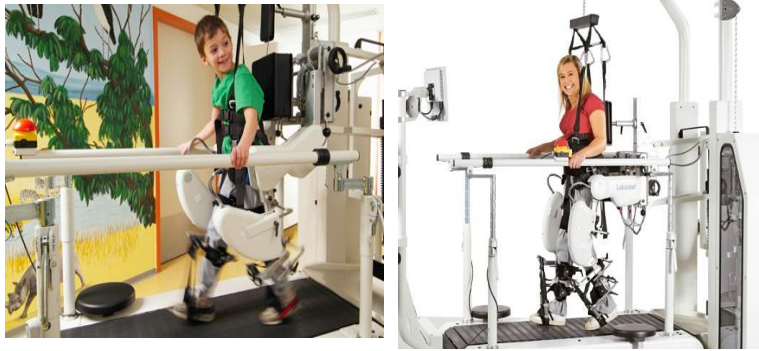
Figura 3.1: Sistema de terapia robotizada Lokomat ® para rehabilitación de marcha de pacientes pediátricos (izquierda) y adultos (derecha) (Colombo et al. , 2001; Riener et al. , 2005).
