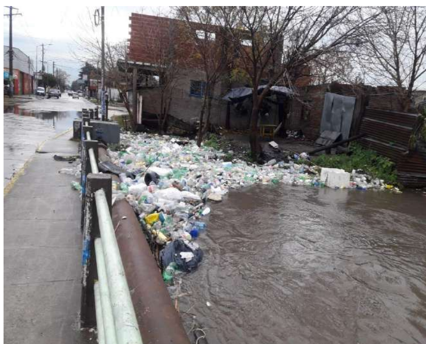
Imagen 8: La fotografía corresponde a la intersección de la calle 844 y el arroyo Las Piedras durante una inundación producto de una lluvia durante el año 2019. La basura acumulada a lo largo del arroyo obstruye el drenaje del curso de agua. Junio, 2019
