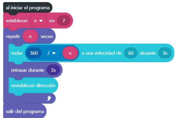
Figura 10. Programa para que Sphero se mueva trazando un polígono regular
