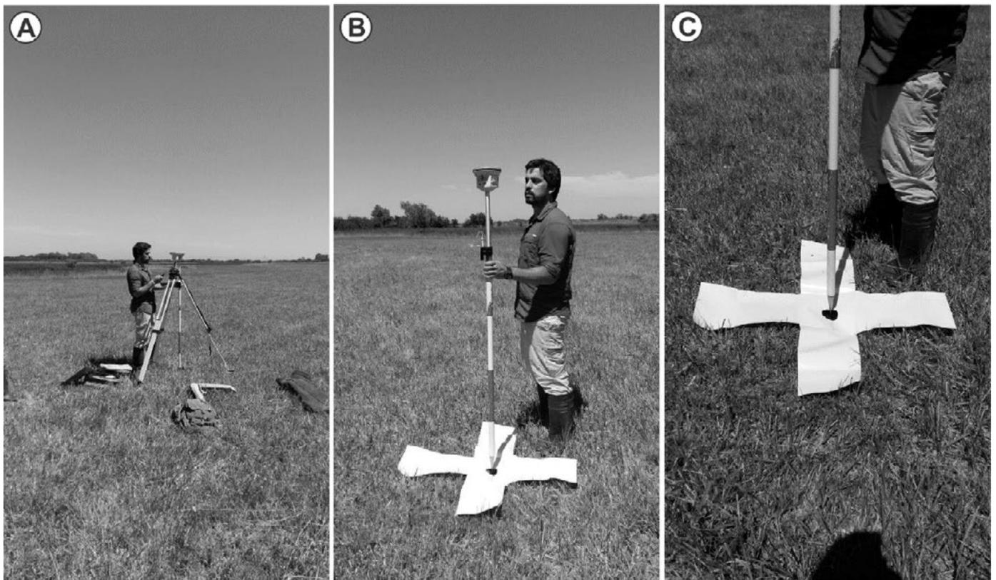
**Figura 2.** Acotamiento de los marcadores topográficos con equipo de GPS diferencial.
