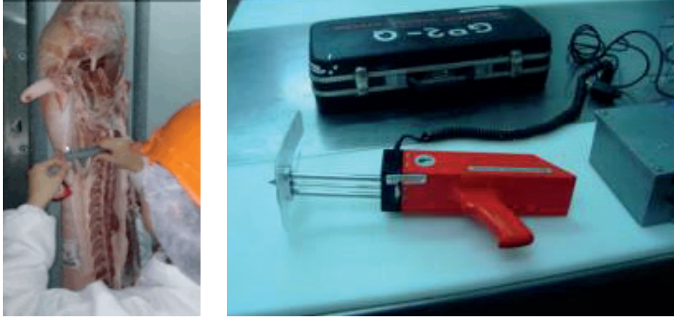
Figura 8: a) Método de la Regletta ; b) Método Fat-o Meter ®
