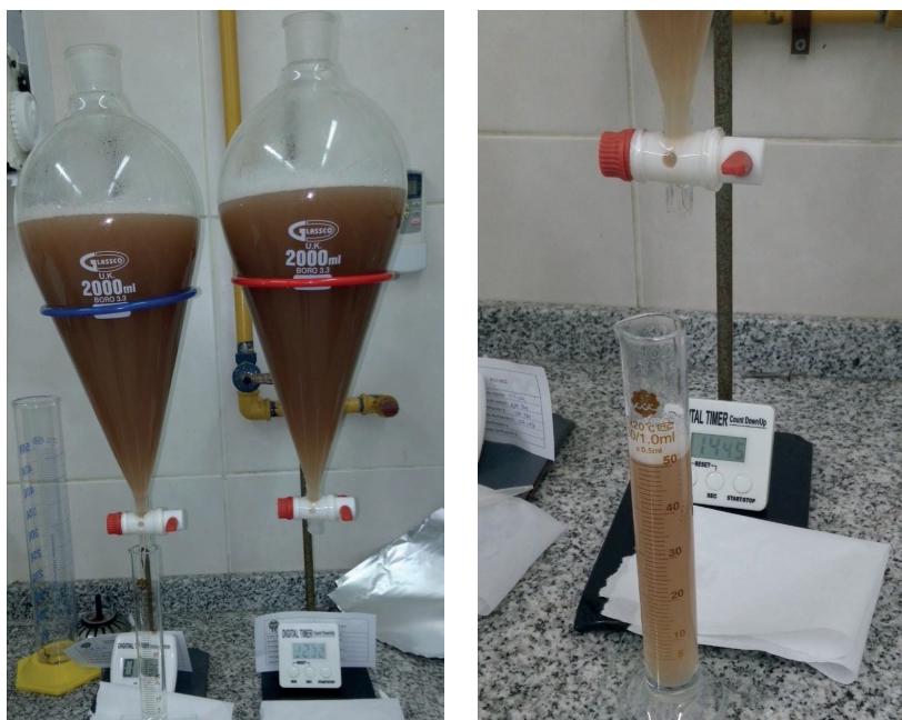
Figura 19: Reposo en ampolla de decantación b) Colecta de 50 ml en probeta y reposo
