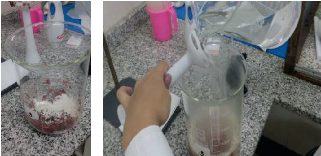
Figura 14: a) Agregado de pepsina, b) Agregado de Agua atemperada.
