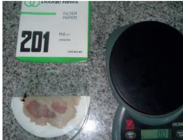
Figura 5: Medición de la Capacidad de Retención de Agua por PAE
