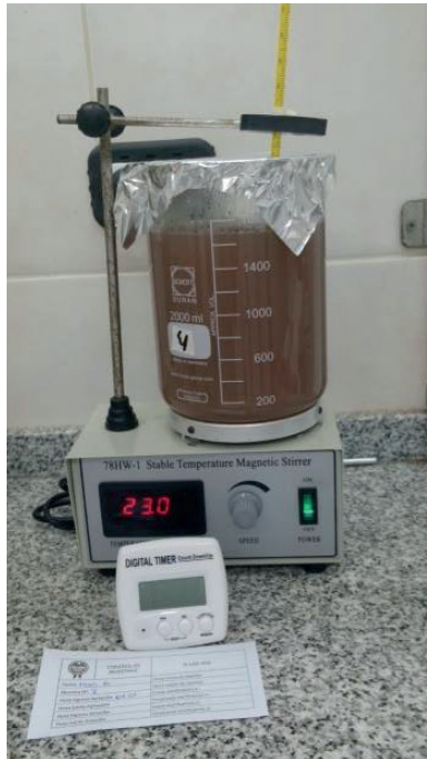
Figura 17: Digestión en vaso de precipitado
