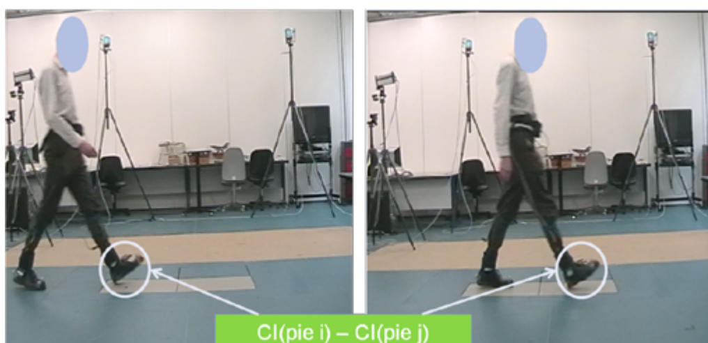
FIGURA 1. Detección del contacto inicial del pie con el suelo para el pie izquierdo (a la izquierda) y derecho (figura de la derecha). La diferencia temporal entre estos dos eventos, se conoce como tiempo de paso y es uno de los parámetros temporales utilizados para la caracterización de la marcha [72].
