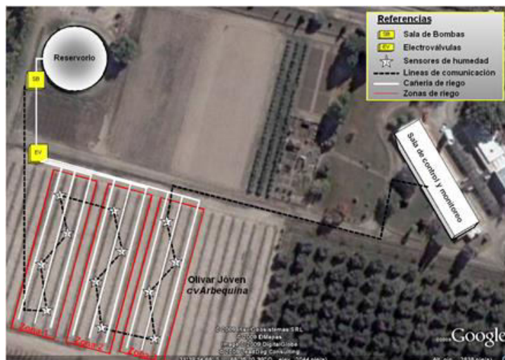
Fig. 5. Vista aérea del lugar de experimentación en INTA - EEA San Juan. Se presenta la demarcación de tres parcelas, cada una de ellas contiene cuatro puntos de medición de humedad de suelo, y la ubicación espacial de los principales componentes instalados.
