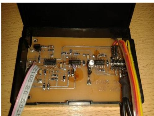
Fig. 4: Amplificador de biopotenciales.
