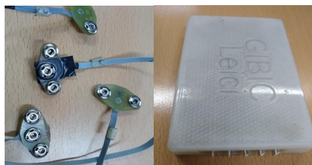
Fig.3. izquierda: sensores diferenciales de EMG, con y sin el electrodo de realimentación de modo común. Derecha: gabinete del WIMUMO con los conectores para 4 canales analógicos y el bus I2C.
