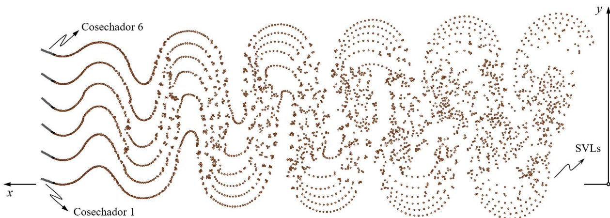
Figura 9: Forma de vibrar de los cosechadores durante el inicio del flutter ( V_\infty = 8.75 m/s) y evolución de las estelas (SVLs).
