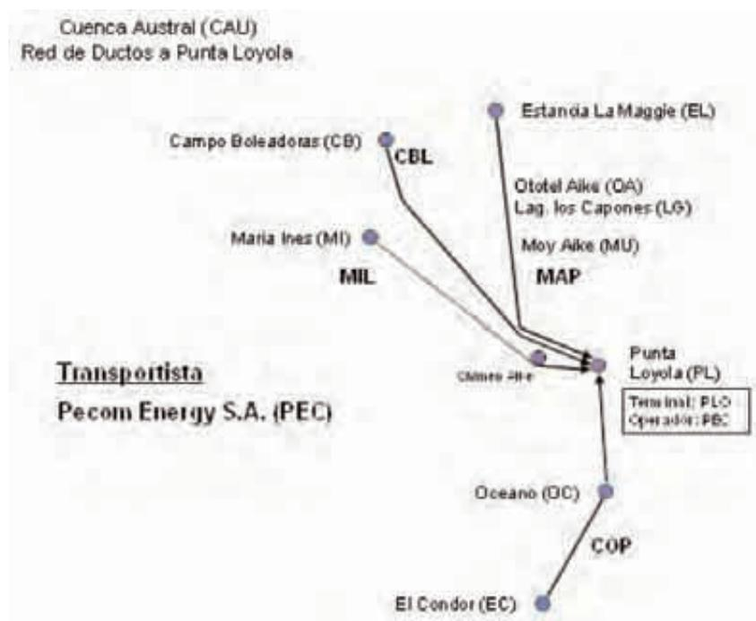
Figura 30. Esquema del trazado de oleoductos de la planta de almacenaje Punta Loyola en la provincia de Santa Cruz operada por Petrobrás Energía.
