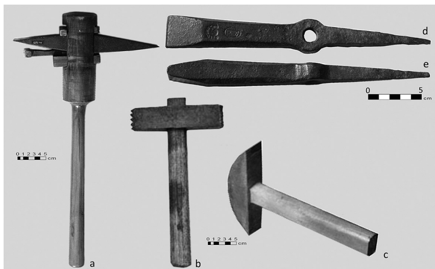
Figura 5. Herramientas de corte y percusión. a, d) Museo Histórico de Chivilcoy. a)- mailloche; b)- bujarda; c)- martellina; d/e)- pico (vista frontal y lateral)
