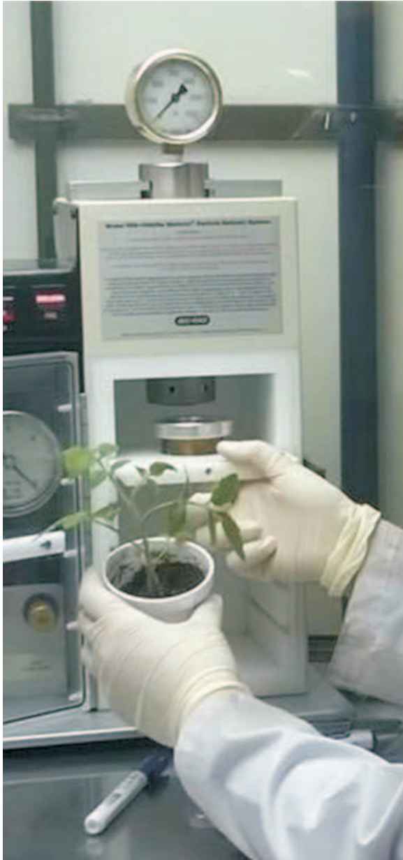
Fig. 3. Acelerador de micropartículas (PDS-1000/He, Biorad®) utilizado para inocularon plantas de tomate (ver resumen Bornancini, V. A. et al)
