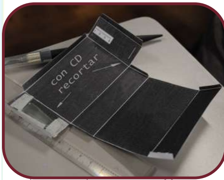
Fig. 11: Recortar y armar el espectroscopio, dejando la parte negra por dentro.
