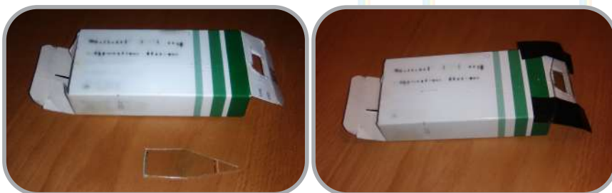
Fig. 19: Espectroscopio con una caja de medicinas y un trozo de CD. Es más sencillo pero no podremos medir longitudes de onda.
