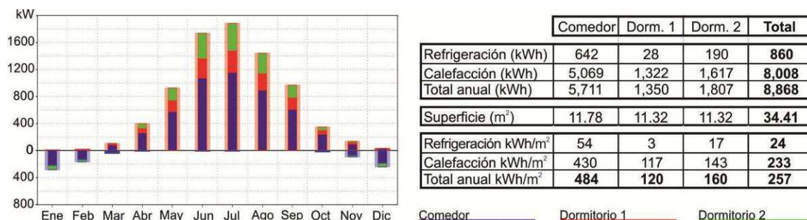
Figura 7 y Tabla 4: comparación de los aportes necesarios para enfriamiento y calefacción de los distintos ambientes seleccionados, para la orientación Sur.
