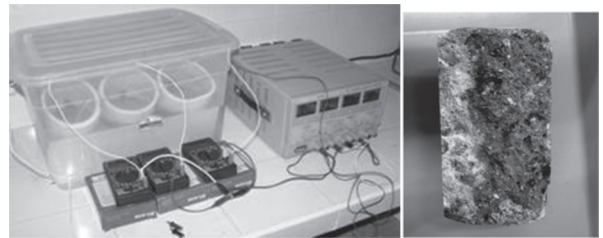
Figura 4. Equipamiento de ensayo de migración de cloruro y perfil de penetración.
