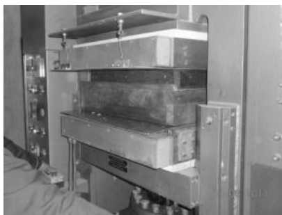
Fig. 8: Prensado de las partículas
