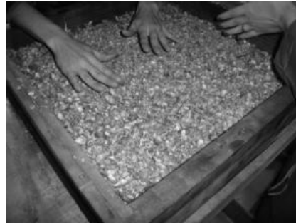
Fig. 7: Conformado del pre-moldeo
