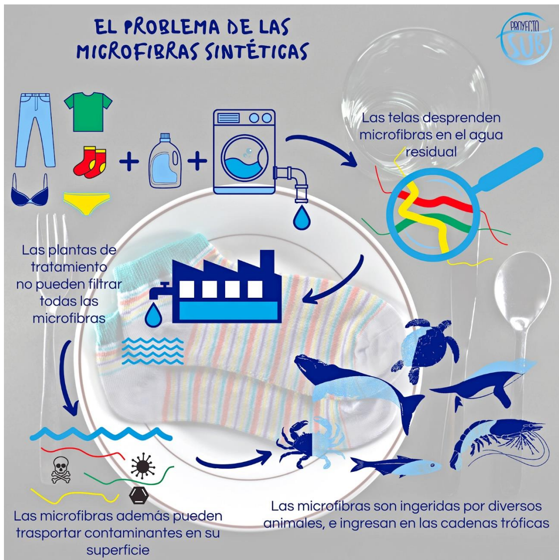
Fig. 1. Esquema ejemplificando una de las principales rutas de llegada de las microfibras sintéticas hasta el medioambiente (tomado y modificado del original: plasticsoupfoundation.org )
