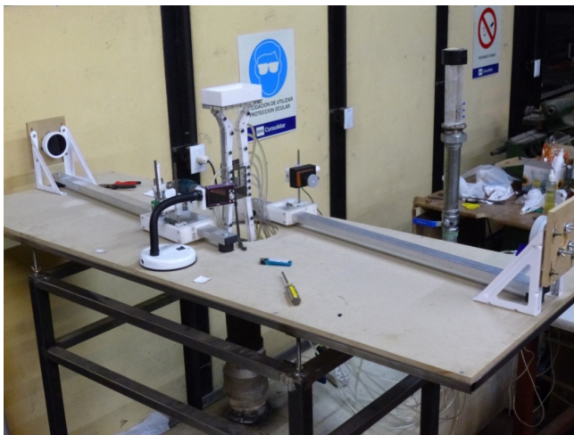
Fig. 7: Vista general del túnel supersónico con el sistema Schlieren montado (Ludueña G. y Peralta L., 2018).
