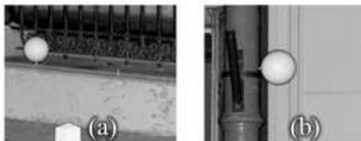
**Figura 9.** (a) Esfera con ubicación apropiada para referenciar mediante mediciones con estación total. (b) Esfera que no posee una ubicación apta para colocar el miniprisma
