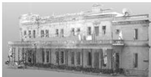
**Figura 18.** Nube de puntos 3D georreferenciada y texturizada de la fachada de rumbo sudoeste del edificio central de la Facultad de Ingeniería.
